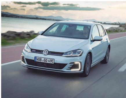
sempre que o Golf GTE é ligado, o modo “e-mode” é acionado automaticamente. Em outras palavras: não há som de ignição. No “e-mode” a velocidade máxima do GTE é de 130 km/h.
